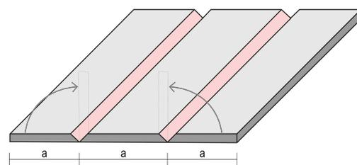
Pour les angles exposés, nous recommandons nos pièces préformées pliées et collées avec protection intégrée dans les angles. La protection est constituée d'une tige ronde en aluminium et est insérée directement sous le carton.
